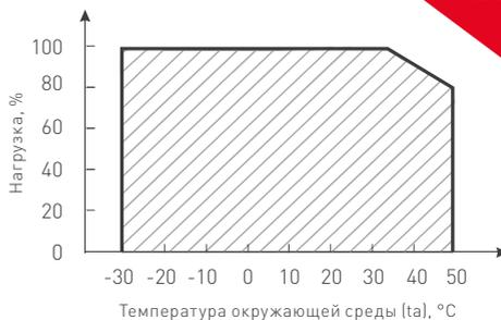
Рис. 2. Максимальная допустимая нагрузка, % от мощности источника.
